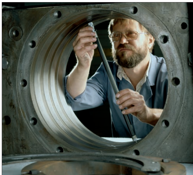
66. Отверстие крупногабаритной подушки измеряется внутренним микрометром
