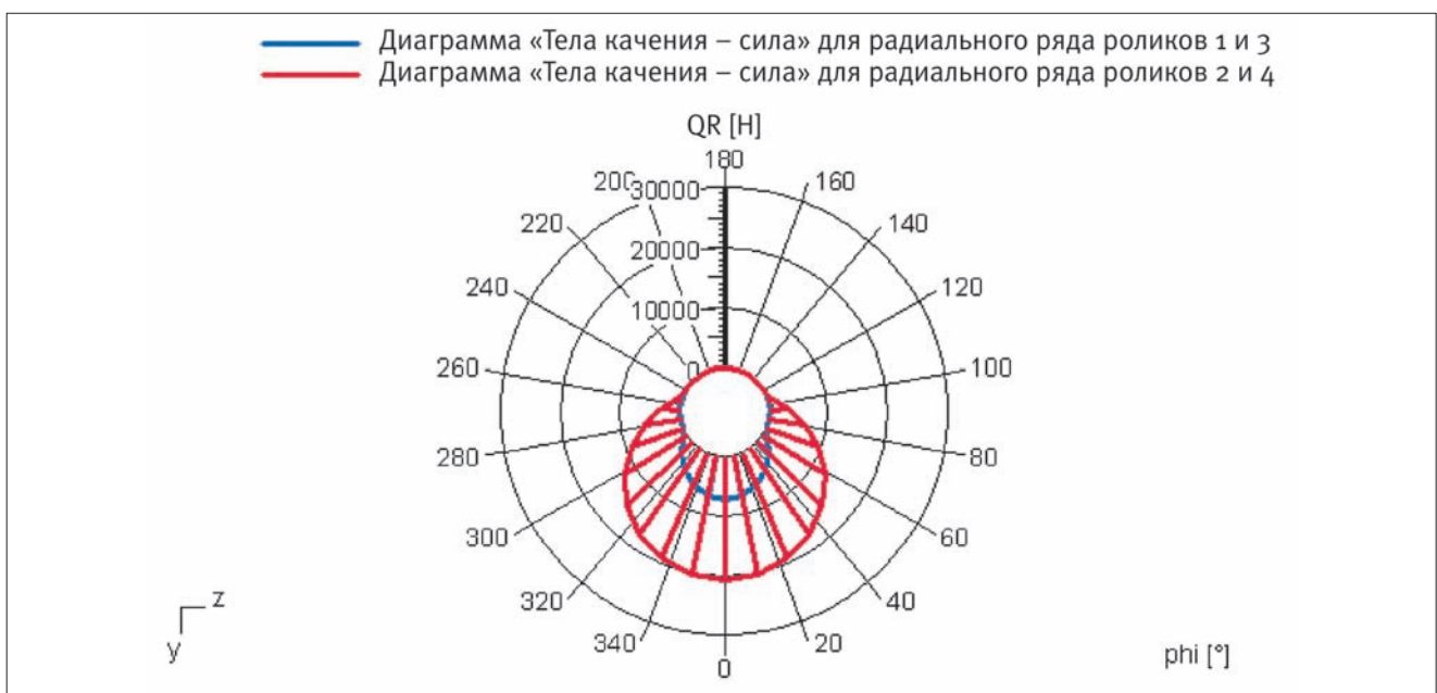
29b. Распределение нагрузки в четырехрядном коническом роликоподшипнике на рабочем валке
