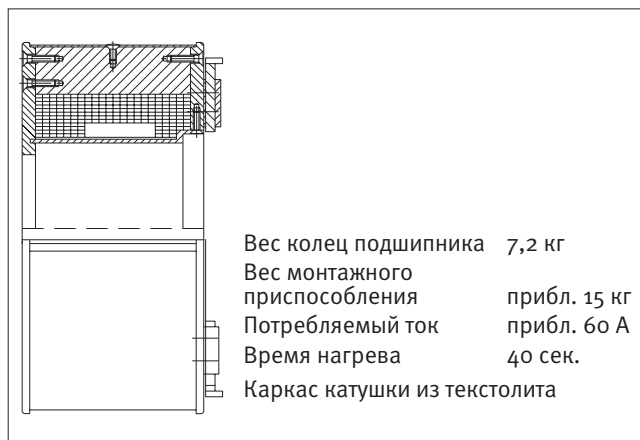
87. Схема индукционного нагревателя для сети напряжением 400 В с педальным выключателем для внутренних колец цилиндрических роликоподшипников диаметром отверстия 130 мм.
